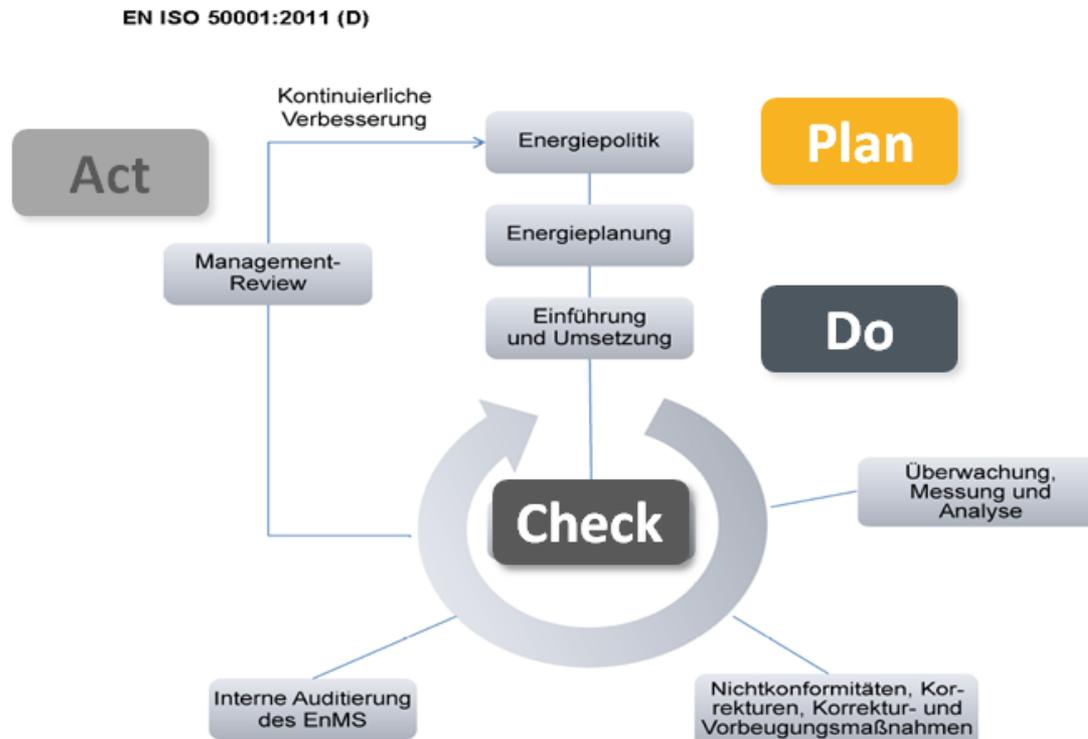
**Bild 1 — Für diese Norm verwendetes Modell eines Energiemanagementsystems**
